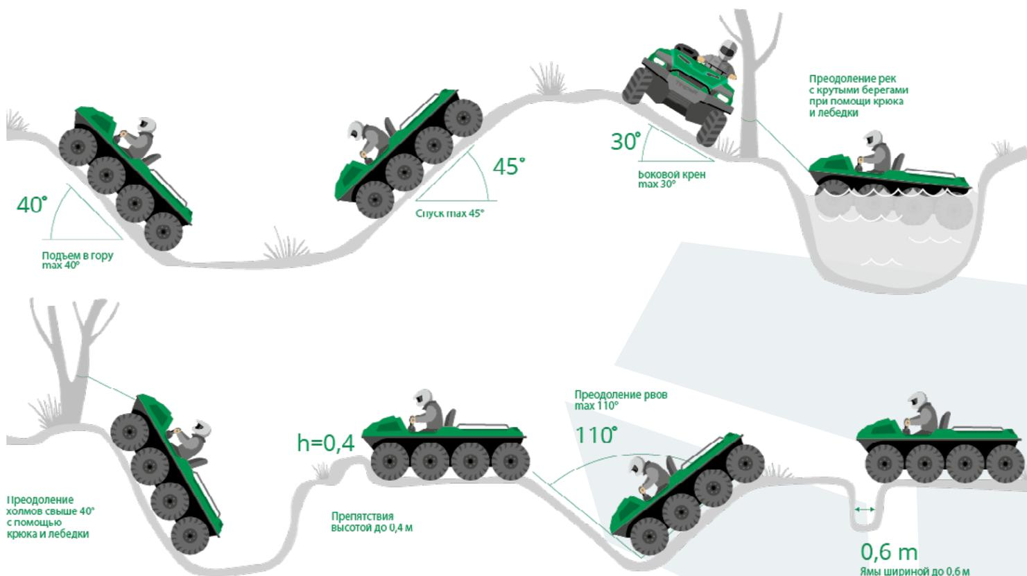
Благодаря широкой базе (1700 мм) и низкому центру тяжести, вездеход обладает высокой устойчивостью. Это позволяет ему передвигаться по склонам с боковым креном до 30°, преодолевать подъемы в 40° и спуски в 45°. Привод на все колеса обеспечивает высокую геометрическую проходимость, вездеход легко преодолевает статические препятствия (пни, камни, поваленные деревья) высотой до 40 см. Без риска вывешивания ведущих колес проезжает ямы (до 60 см) и рвы.
