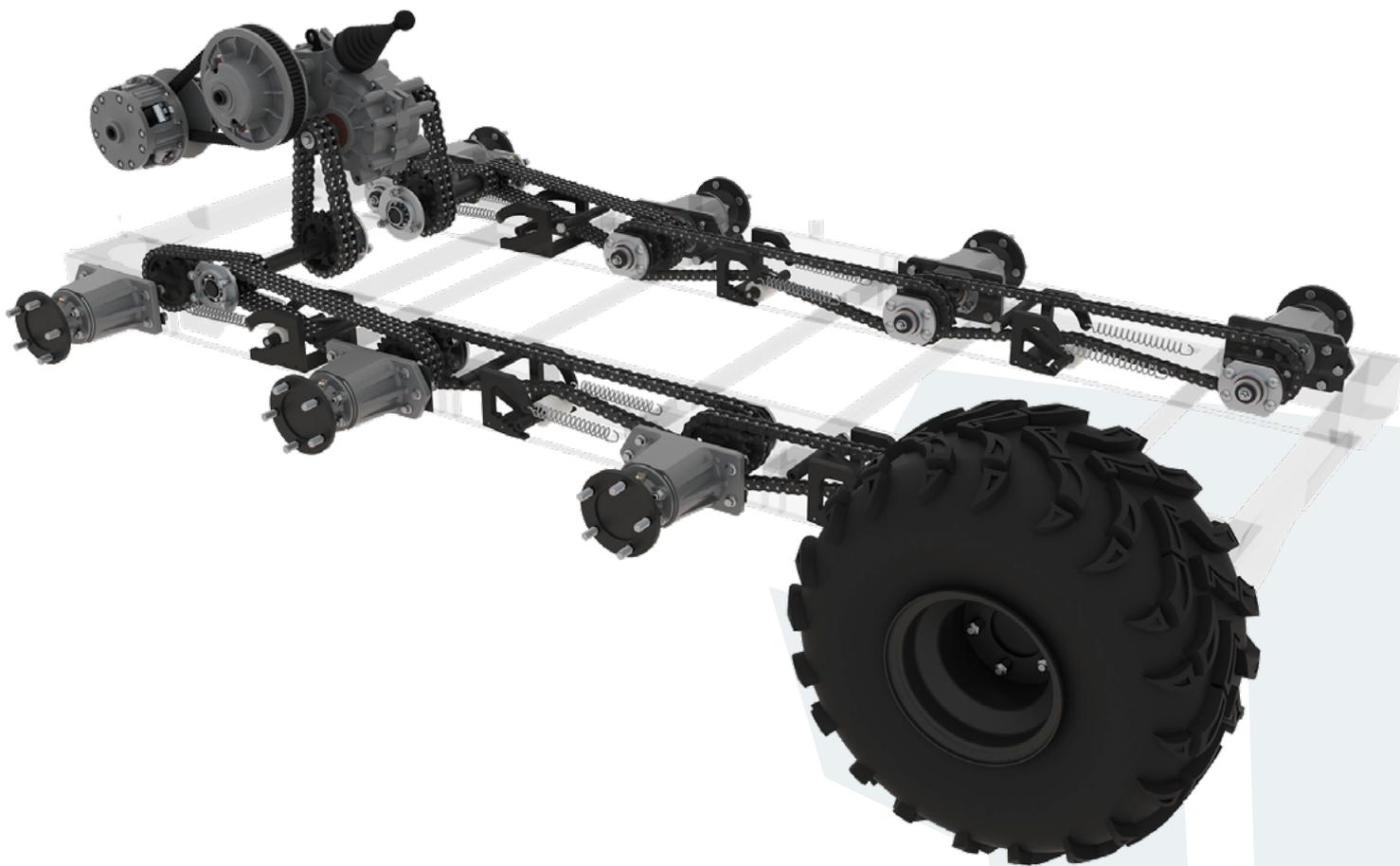
**Коробка передач** имеет повышенную, пониженную передачи, задний ход и нейтральное положение. Передача крутящего момента осуществляется через бесступенчатый вариатор. Максимальная скорость вездехода 35 км/ч. Привод на все колеса цепной с автоматическими натяжителями (цепи RENOLD, Германия). Высокую надежность ходовой обеспечивают усиленные полуоси, прочность которых в 1.5 раза превышает максимальные нагрузки.
